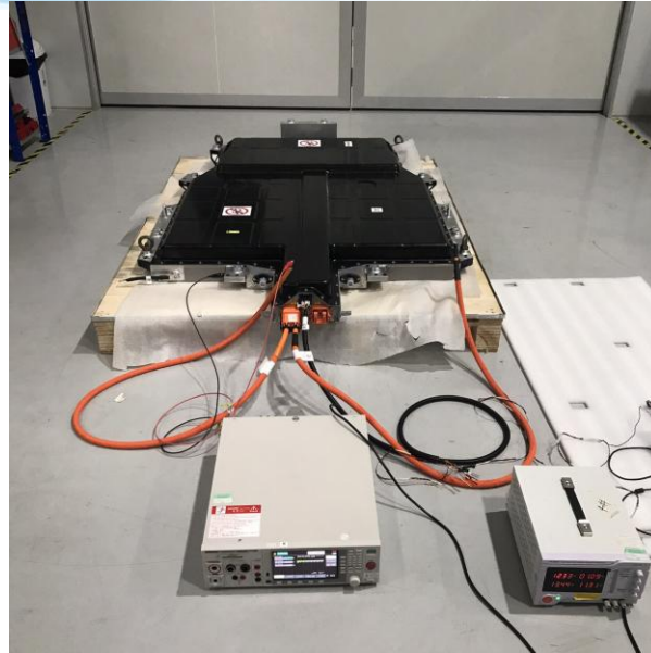
รูปที่ 4 การติดตั้งแพ็คเกจเตอรี่ร่วมกับเครื่องมือวัดและระบบ charge/discharge ที่มา: STI Environmental Reliability Laboratory
