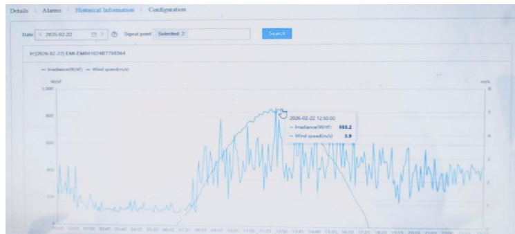
รูปที่ 5 กำลังไฟฟ้าของความเข้มของรังสีแสงอาทิตย์และความเร็วลม (วันที่ 22 กุมภาพันธ์ 2569)
